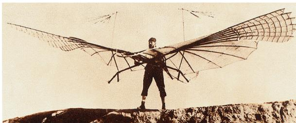
das Profil der Tragflügel wichtig ist. Er entwickelte einen neuen Gleiter, der über eine gewölbte Tragfläche verfügte - diese Idee war der Durchbruch. Im Jahr 1891 startete er mit seinem Gleiter - ein paar Holzverstrebungen mit Papier verkleidet - und er segelte rund 25 Meter durch die Luft. Das war der
